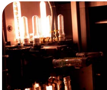
Horno de calentamiento de preformas con mínima distancia entre ellas y amplia zona de homogeneización.
