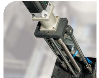
Sistema de estirado de preformas mediante servomotor eléctrico.
