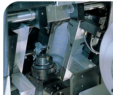
Disposición del cabezal en relación a los moldes.
